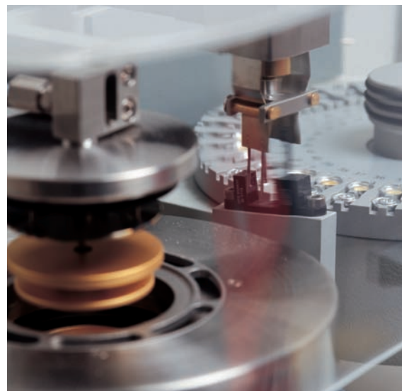
Mit dem DSC-Messgerät können beim Wareneingang die Erweichungs- und die Schmelztemperatur des Materials ermittelt werden.
